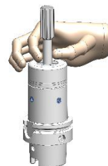
Bild 3 – Werkzeug einstecken und Spannmutter von Hand spannen
