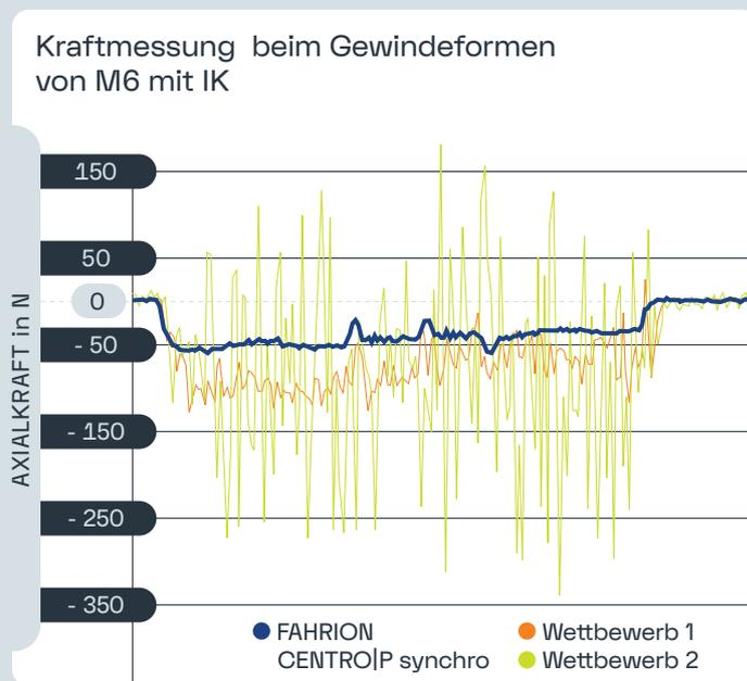
Kraftmessung beim Gewindeformen eines M6 Gewindes mit Synchronfutter bei ausgeschalteter interner Kühlschmierstoff-Zufuhr
