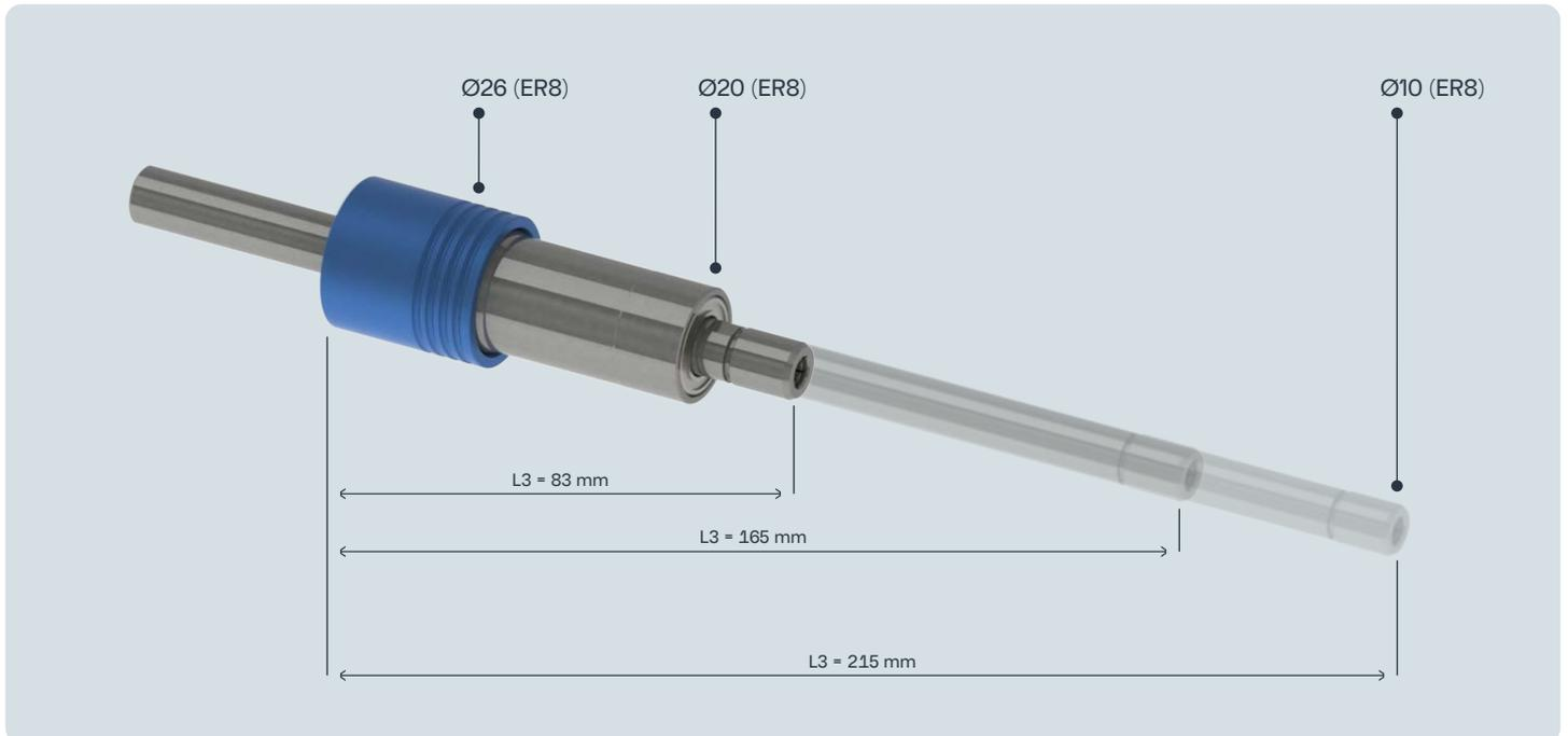
Das FAHRION spezifische Design der Führungen gewährleistet höchsten Rundlauf auch bei langer Auskragung. Die Rubber-Flex-Clutch (RFC) übernimmt dabei die erforderlichen Dämpfungseigenschaften in axialer und radialer Richtung. Dabei kommt unser Mini Synchro Chuck MSC8 mit einem Durchmesser von 10 mm an der Spannmutter aus.
