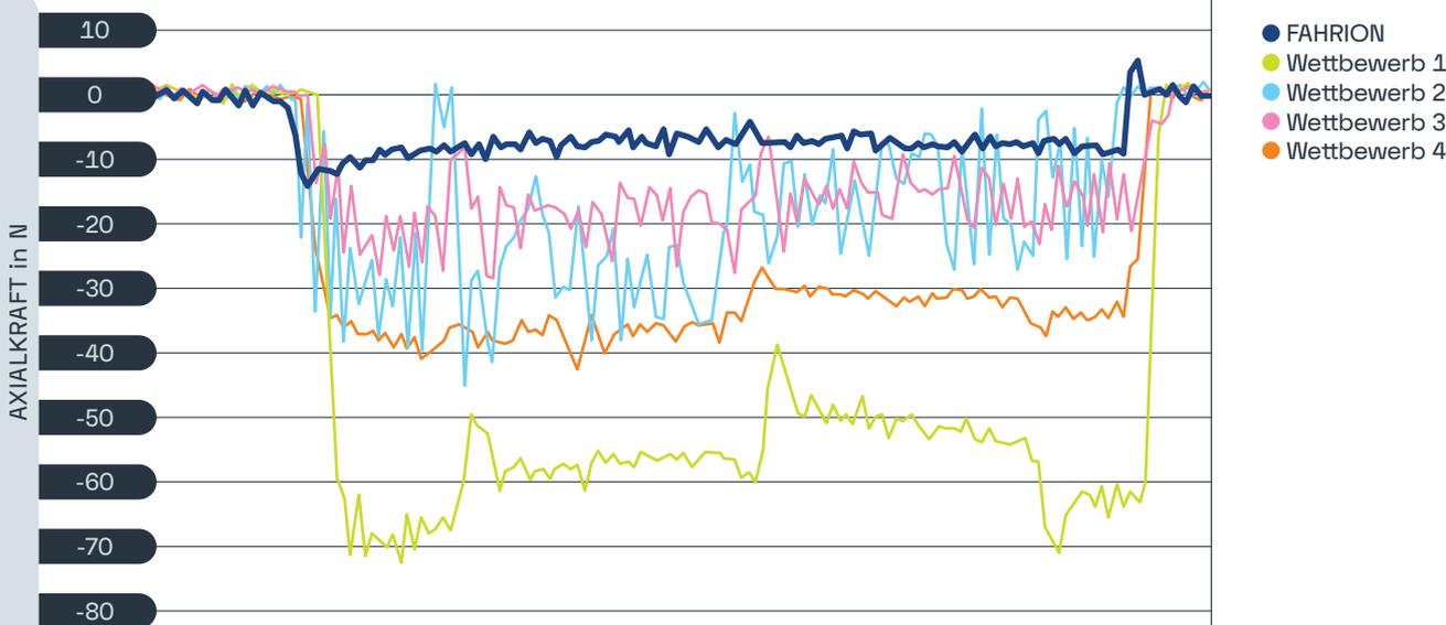
Jeder Maschinenbauer weiß: „Bei gleichzeitigem Drehen und Ziehen klemmt's.“ Eine bestehende Grundproblematik, die unter Drehmomentlast durch Kugeln, Stifte oder vergleichbare Mitnehmer entsteht.
