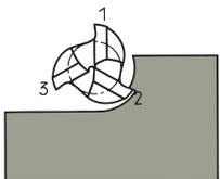
Werkzeugverschleiß wird größer, Oberflächengüte wird schlechter
