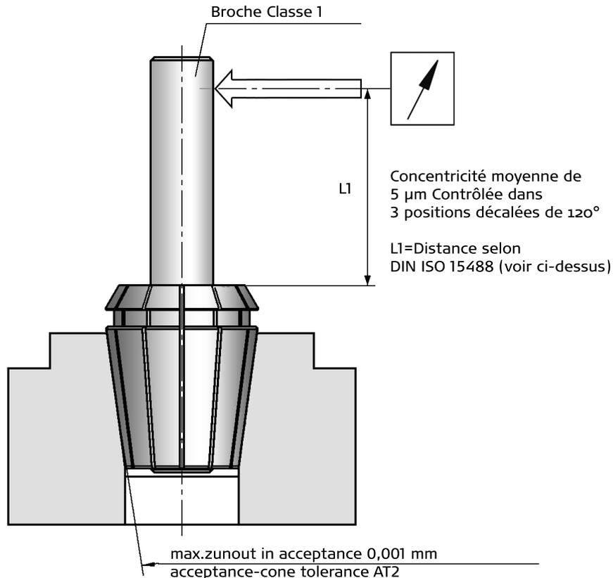
Pour les applications qui exigent une concentricité maximale, il est indispensable de prendre en considération la précision de tout l'ensemble du système (broche de la machine-outil, logement de la pince, écrou, pince de serrage et outil de coupe).
