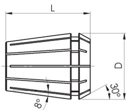
Pinces de serrage de précision GERC-B - 5 µm de GERC11-B à GERC40-B
