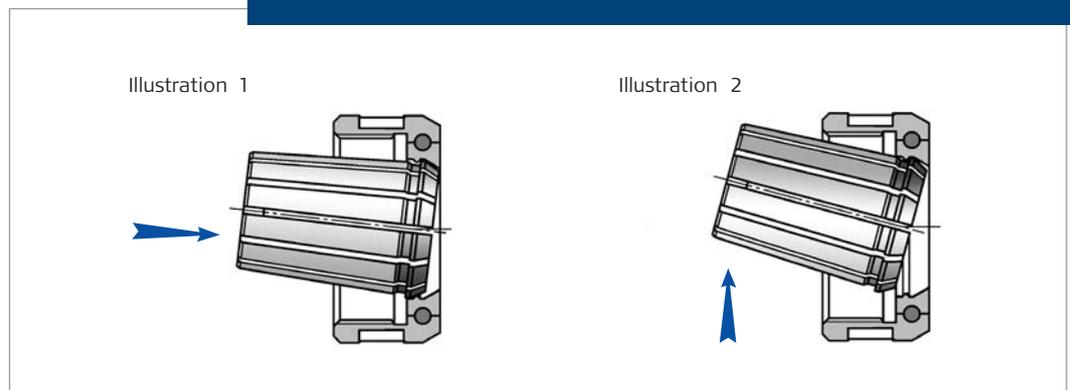
**Montage (Illustration 1) :** Mettre la pince dans la gorge et presser dans la direction de l'axe jusqu'à la butée.
