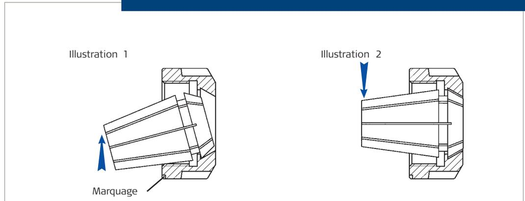
**Montage (Illustration 1) :** Accrocher d'abord la pince de serrage à l'endroit marqué de l'écrou de serrage, en biais, avec la rainure dans la bague excentrique de l'écrou de serrage • basculer dans la direction opposée jusqu'à ce que la pince de serrage s'enclenche complètement • insérer la pince de serrage enclenchée avec l'écrou de serrage dans le logement de la pince de serrage et, si possible, serrer avec une clé dynamométrique.
