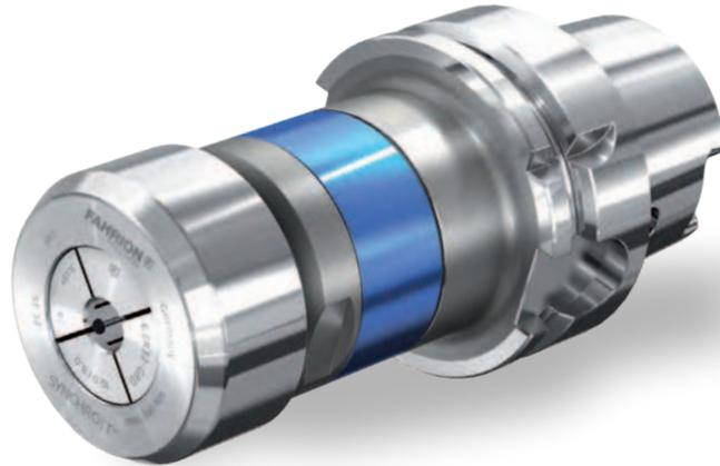
Le mandrin de taraudage SYNCHRO|T sert à la compensation des différences de pas de l'outil de taraudage et de la broche de synchronisation, ainsi que pour la compensation des tolérances de pas de l'outil de taraudage. Il intervient en tant qu'élément amortisseur entre l'outil et la broche lors du taraudage synchrone (Rigid Tapping) sur les centres d'usinage à broches synchrones.
